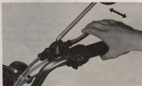
Fig. 2-19 Réglage automatique de frein avant
