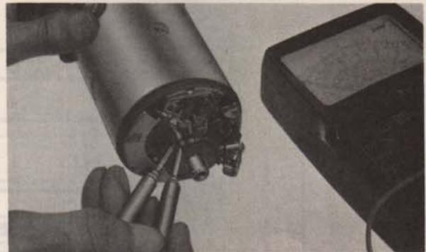
Fig. 3-107 Contrôle de l'état de l'enroulement d'induit
