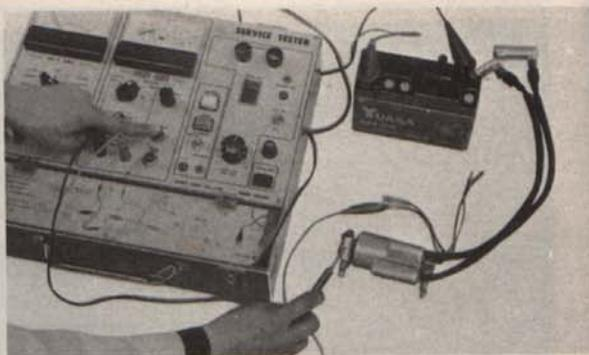
Fig. 3-99 Contrôle de l'état du condensateur
