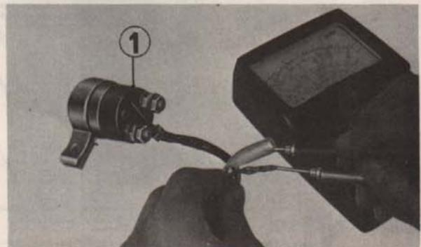
Fig. 3-108 (1) Relais magnétique de commutateur de démarrage
