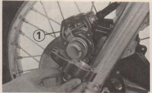
Fig. 4-28 (1) Joint d'étanchéité de couvercle de l'étrier
