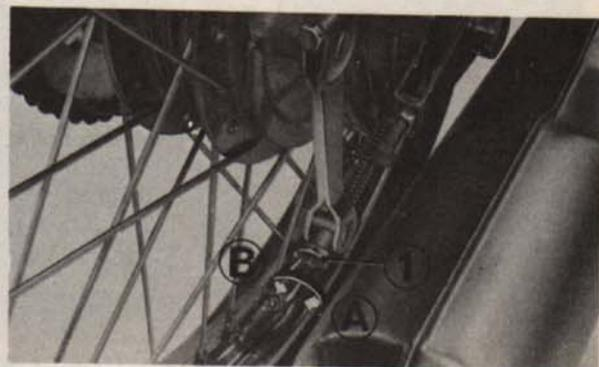
Fig. 2-21 (1) Ecrou de réglage de frein arrière
