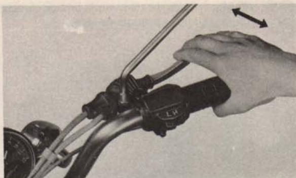
Fig. 4-30 Réglage automatique du frein avant
