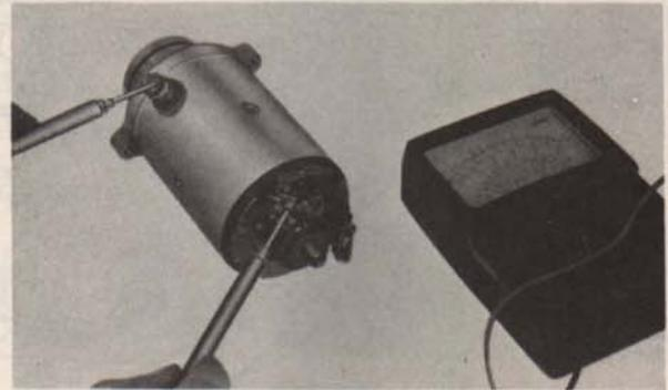
Fig. 3-106 Contrôle de l'état de bobine fixe
