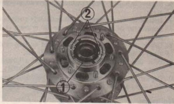
Fig. 4-8 (1) Flasque de roulement à billes
