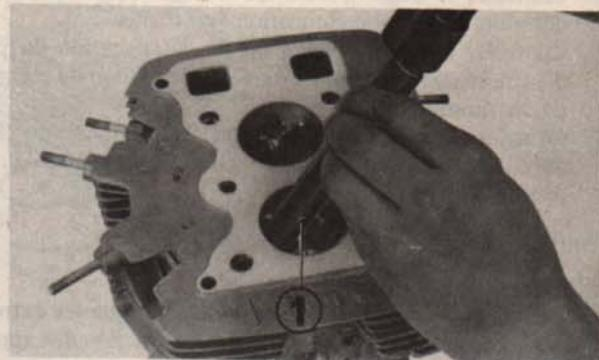
Fig. 3-12 (1) Extracteur de guide de soupape
