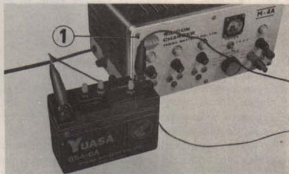
Fig. 3-94 (1) Chargeur de batterie
